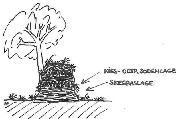
Abb. 1: Feldskizze A: freistehender Seegraswall, z. T mit Zwischenlagen aus Strandkies; Funktionen: Hochwasserschutz, Feldgrenze, Gemeindegrenze; Beispielorte Falsterbo, Skanör, Møn, Nyord, Skarø, Ebeltoft (Eigene Grafik)
