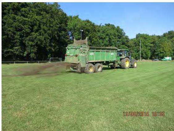
Abb. 3a: Ausbringen von treibselbasierter aktiver Abdeckschicht zur Instandsetzung von Sportplatzrasen (Foto: Martin Staemmler)
